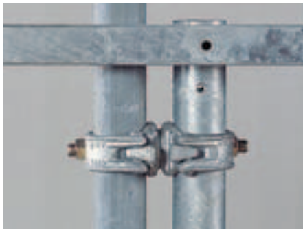
Enkel tilkopling av stillasrør Ø 48,3 mm med vridbar kopling DK1.
