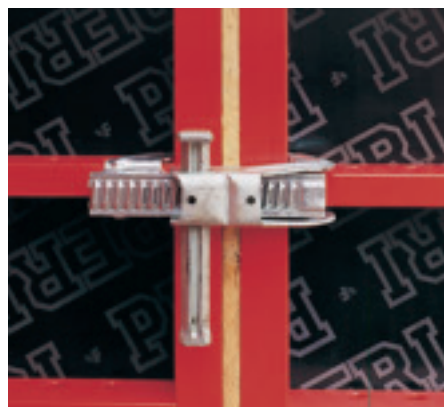
Spanner over treutfyllinger opp til 100 mm brede
