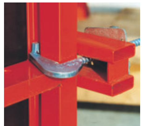
TAR 85 og flagganker holder treverket på plass.
