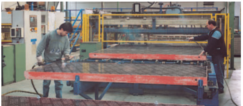
Maskinen nagler den nye fineren nøyaktig fast i den rengjorte stålrammen. Rundt fylles med silikon.
