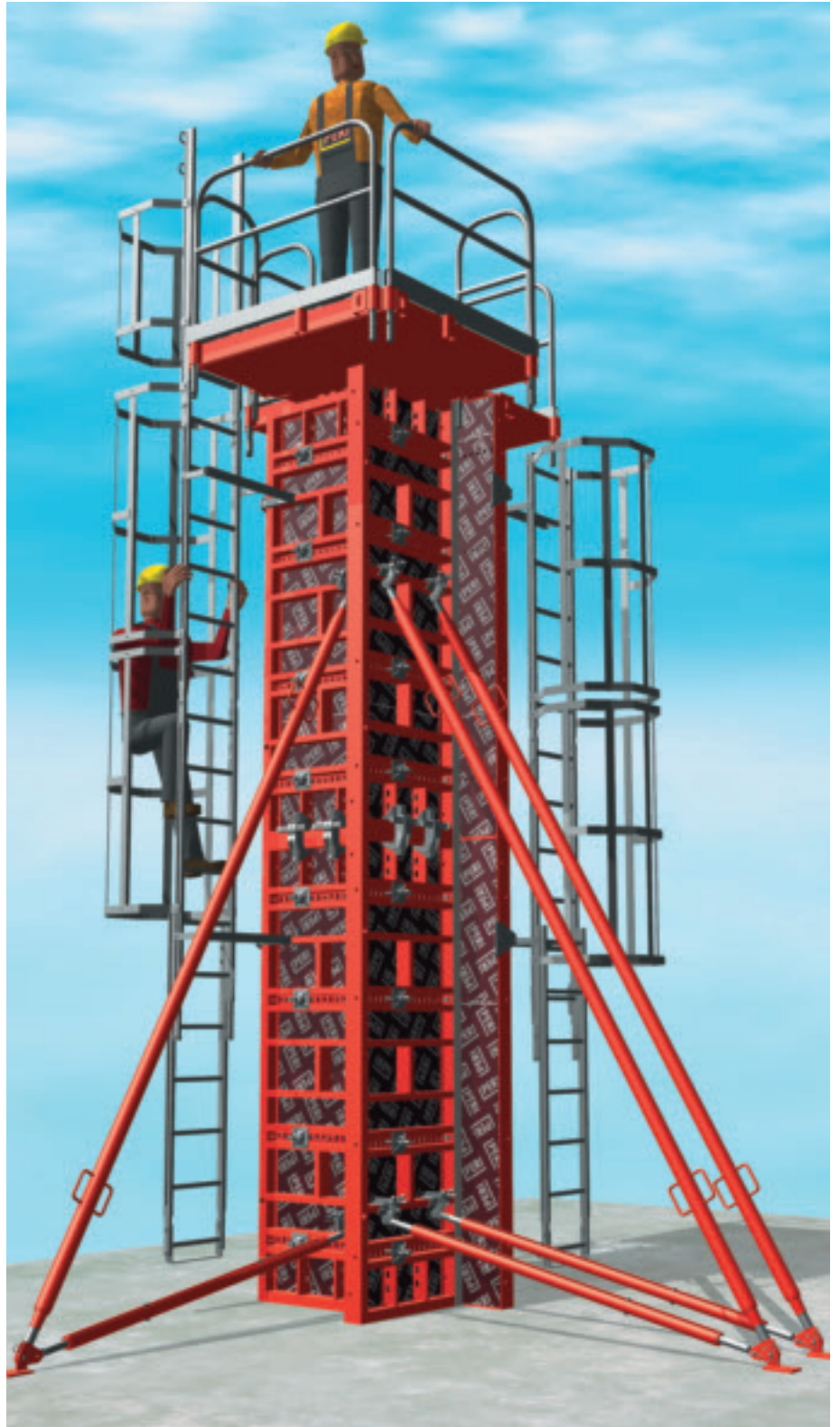
Komplett TRIO søyle 5,40 m høy, med støpeplattform, stigeoppgang og skråstøtter.
