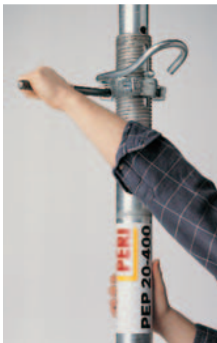
PEP-støttene kan også lett justeres med en trekkstang og også senkes med full belastning.
